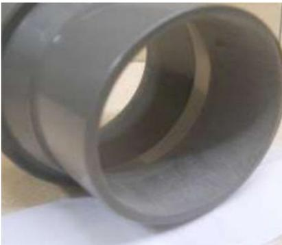
**Langkah keenam** adalah menyiapkan overshock 2,5" ke 2" selanjutnya ampelas sehingga pipa 2" dapat mudah terpasang pada overshock
