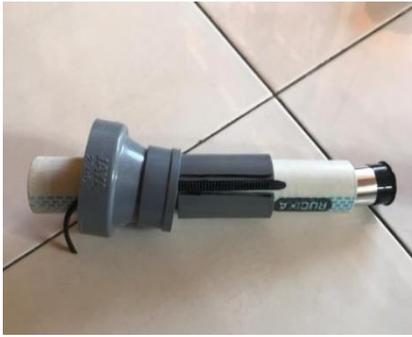
**Langkah ketujuh** adalah memotong overshock 2" ke 1,25" sampai sisa 1cm, selanjutnya sambungkan overshock dengan pipa 2" dengan panjang 12,5 cm
