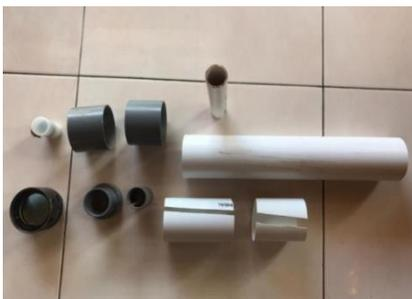
**Langkah ketiga** adalah menciptakan dudukan lensa pada pipa dengan posisi kedalaman kurang lebih 3,5cm sehingga chasis lensa dapat masuk
