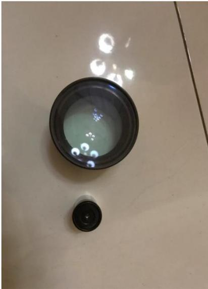
**Langkah pertama** adalah gunakan lensa fotocopy. Lensa yang akan digunakan hanya dua buah lensa (Lensa Cembung dan Lensa Cekung) dilengkapi tempat dudukan lensa. Kegiatan selanjutnya adalah memotong besi melintang pada dudukan/ casing lensa fotocopy.
