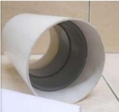
**Langkah kelima** adalah menempelkan Shock berukuran 2,5" dengan pipa berukuran 3" menggunakan lem. Hal tersebut dilakukan dengan tujuan agar tabung teleskop memiliki baffle.
